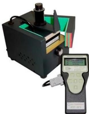
Рисунок 2.7 – Прибор для измерения теплопроводности ИТП-МГ4 «100»
