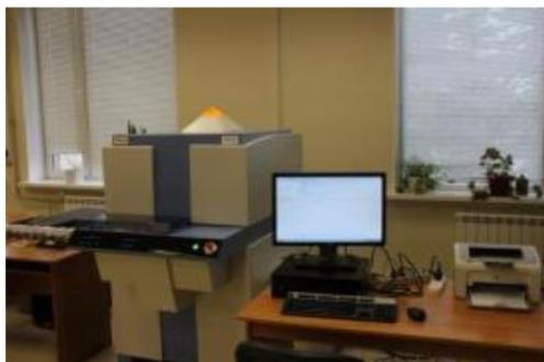
Рисунок 2.5 – Рентгено-флуоресцентный спектрометр серии ARL 9900 WorkStation
