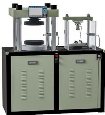
Рисунок 2.6 – Общий вид машин МИФ – 600.1.2.С
