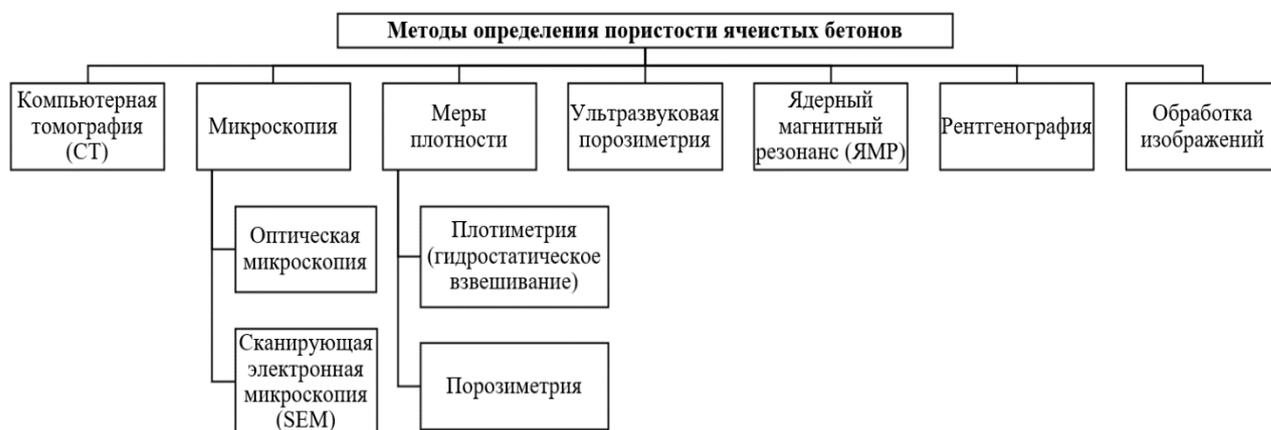
Рисунок 1.8 – Методы определения пористости ячеистых бетонов
